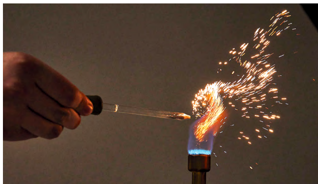
Im Schullabor geht es zum Beispiel um die Besonderheit von Nanopartikeln: Je nach Größe ändert sich die Eigenschaft. Während ein Nagel aus Eisen nur glüht, sprüht Eisenpulver Funken, wenn es erhitzt wird.
